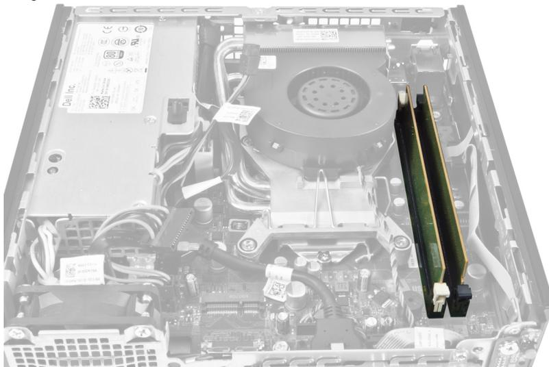
3. Pressione para baixo os cliques de fixação de memória em cada lado dos módulos de memória e remova os módulos dos seus conectores na placa de sistema.
