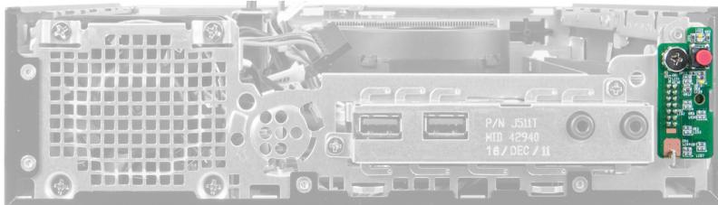
3. Desconecte o cabo da chave liga/desliga do chassi.
