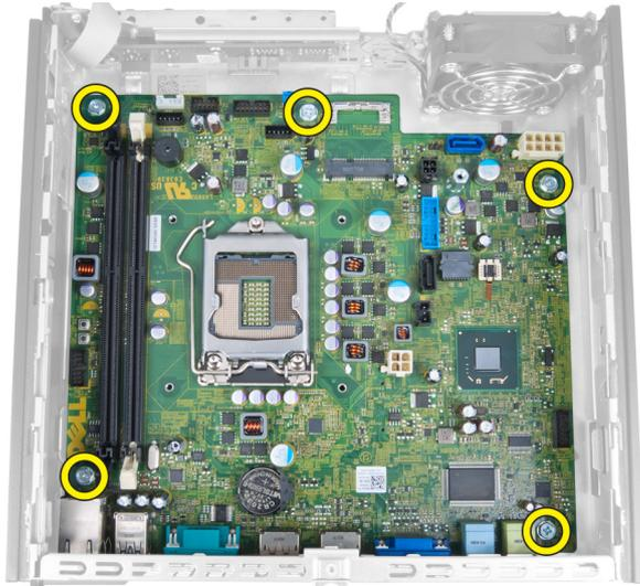
6. Remova o parafuso de cabeça sextavada de 7 mm da placa de sistema.
