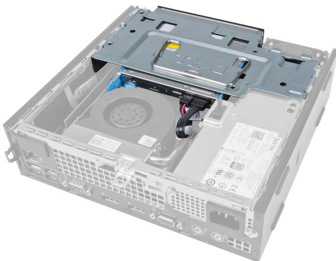
3. Remova o cabo de dados e o cabo de alimentação da unidade óptica.
