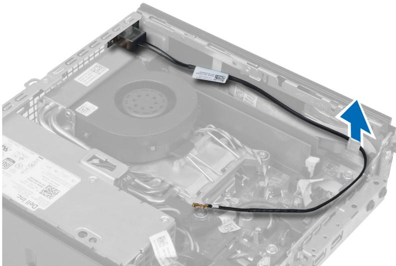
5. Remova os parafusos que fixam o disco da antena ao conector. Remova o disco da antena do computador.
