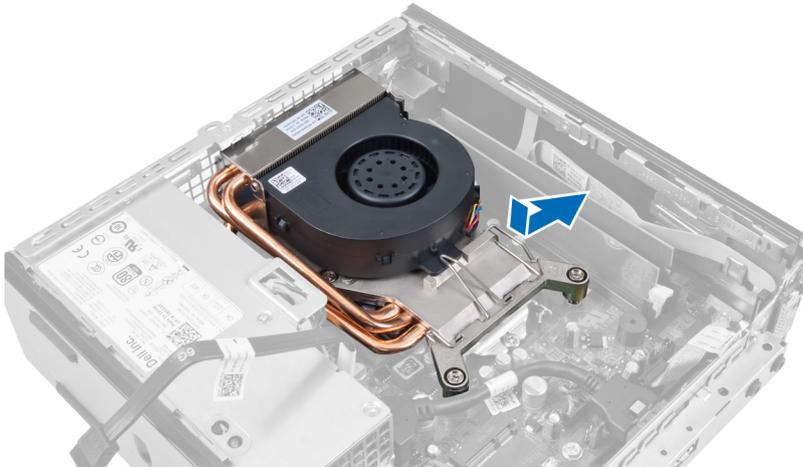
5. Levante a parte superior do conjunto dissipador de calor/ventilador.
