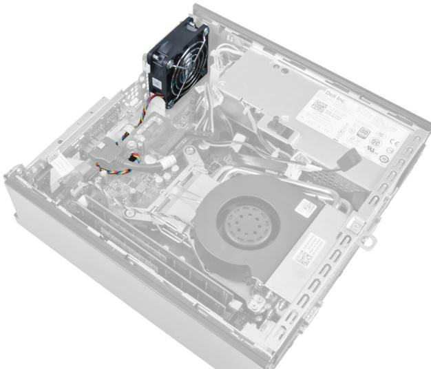
3. Desconecte e remova o cabo do ventilador do sistema da placa de sistema.
