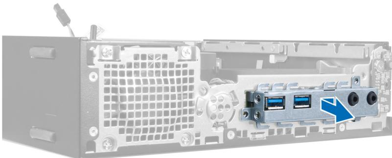
6. Remova os parafusos que fixam o painel de E/S ao gabinete.
