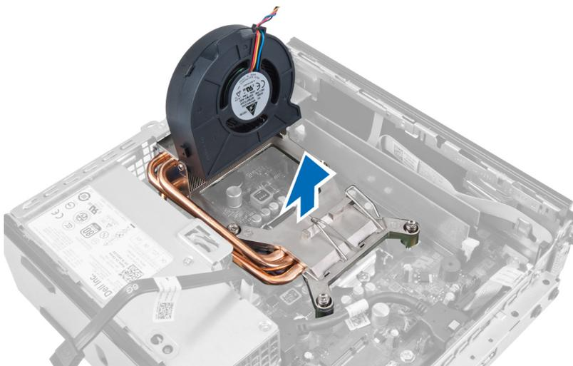
Coloque o conjunto com o ventilador voltado para baixo, e com a graxa térmica voltada para cima.
