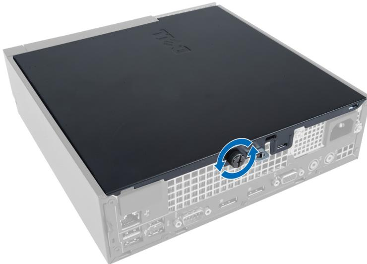
3. Puxe a tampa em sua direção e levante a tampa para removê-la do computador.
