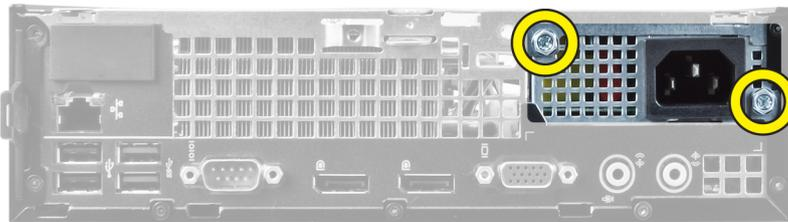
6. Deslize a fonte de alimentação para dentro e levante-a para fora do computador.
