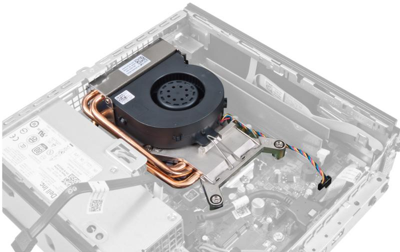
3. Desconecte o cabo do conjunto dissipador de calor/ventilador da placa de sistema.
