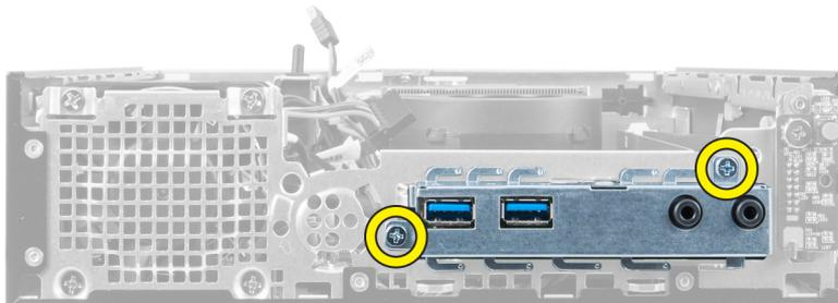
5. Deslize o painel de E/S para a esquerda do computador de forma a liberá-lo e puxe-o junto com seu cabo para fora do computador.
