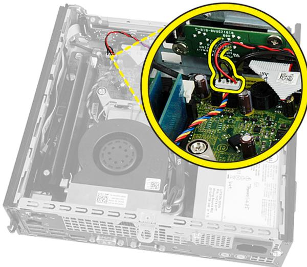
4. Remova o cabo do alto-falante de sob o cabo do ventilador do sistema e das antenas (se instaladas) da rede local sem fio (WLAN).
