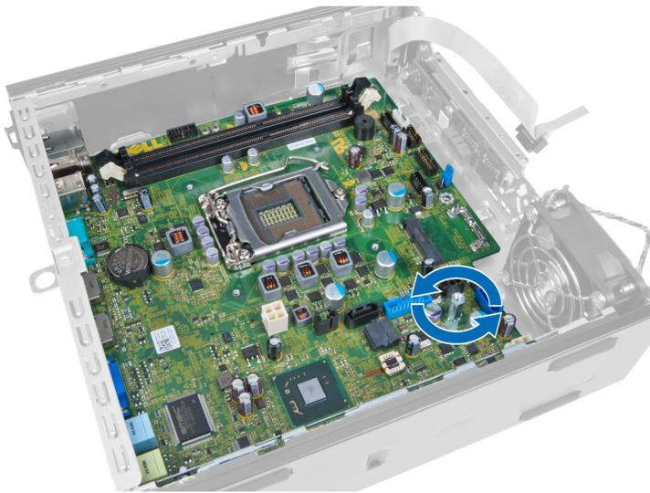
7. Deslize a placa de sistema em direção à frente do computador e remova-a.
