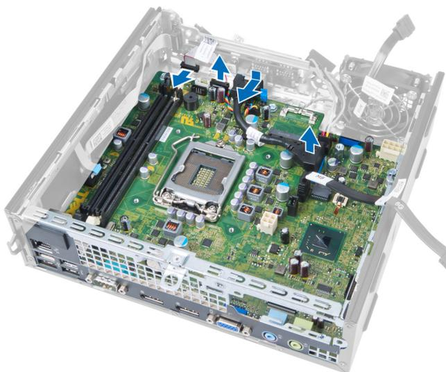
4. Desconecte todos os cabos conectados à placa de sistema.
