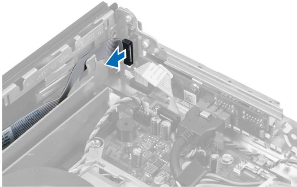
4. Remova o parafuso e puxe a placa da chave liga/desliga para fora do computador.
