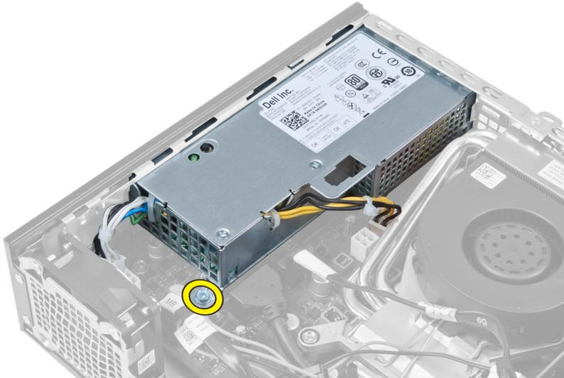
5. Remova os parafusos que prendem a fonte de alimentação ao chassi.
